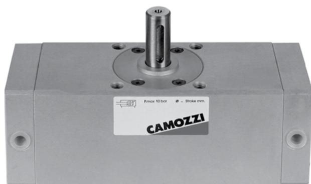
Los cilindros rotativos de la Serie 30 han sido realizados utilizando un perfil de aluminio especial. Sus dimensiones muy reducidas y su esmerado diseño hacen de estos productos unas piezas estéticamente agradables. Gracias a un patín guía antidesgaste, estos cilindros tienen una vida muy prolongada. Están previstos unos registros de posicionamiento para los ángulos operativos.
