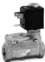
El piloto de estas válvulas controla la posición del diafragma a través de una presión diferencial. Estas válvulas son excelentes para el control de los altos rangos de flujo de fluidos y requiere presiones muy bajas de trabajo.
