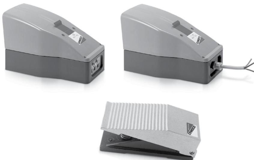
El pedal está disponible tanto en versión neumática como eléctrica. En la versión neumática está disponible con una válvula 5/2 vías y 3/2 NC con conexiones de M5; G1/4 y tubo 4/2. Las conexiones neumáticas frontales, facilitan el montaje de racores y silenciadores. La versión eléctrica en la serie 3 está disponible con un microinterruptor con contactos unipolares, la salida del cable es frontal (PG9).
