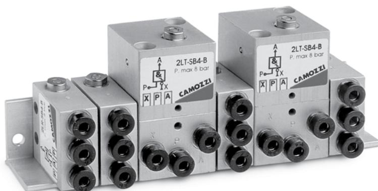
Las funciones lógicas de base de la serie "2L" han sido realizadas en 5 modelos diferentes y se pueden instalar separadamente gracias a los orificios pasantes en el cuerpo. La escuadra 2LQ - 8A permite el montaje en batería, ubicando las entradas y salidas frontalmente, facilitando el montaje de los tubos de conexión.
